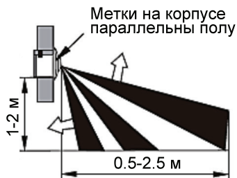
Диаграмма направленности датчика в вертикальной плоскости (вид сбоку)
