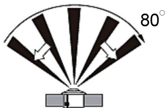
Диаграмма направленности датчика в горизонтальной плоскости (вид сверху)
